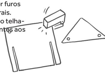
6 Alinhe os furos e atravesse-os com um conector. Lembre-se de travar os conectores.
